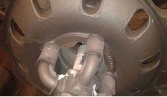
Şekil 12a: HOLLLOTEX Shroud ile tekerlek gövdesi çatlaması
