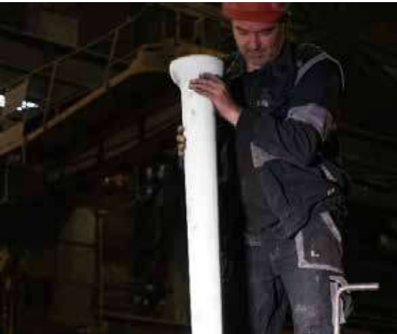
▲ Şekil 6a: Hazırlanmış kalıbın içerisine HOLLOTEX Shroud yerleşimi
