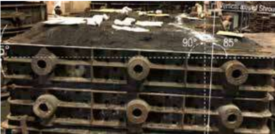
Şekil 8a: HOLLOTEX Shroud zor kalıpların da dökülmesine imkan verir
