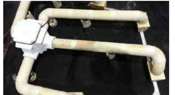
▲ Şekil 15a: HOLLOTEX Shroud filtre kutusu takılı yolluk sistemi
