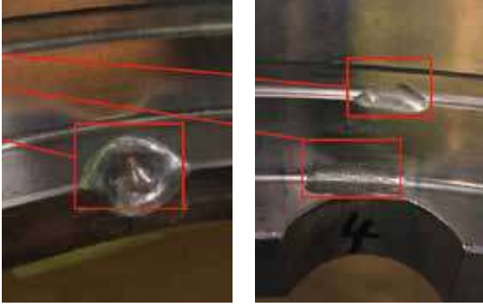
▲ Şekil 13b: Hata giderme ve kaynak
