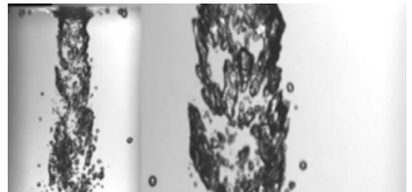
▶ Şekil 2c: Sıvı metal aktarımı, hava sürüklenmesine ve bifilmli neden olur
