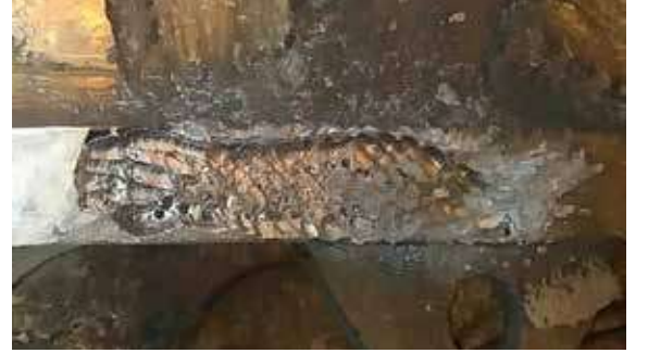
▲ Şekil 14a: Üst yüzeydeki tipik gaz hataları
