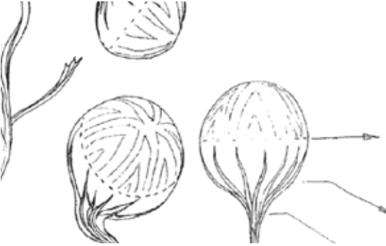
Şekil 3a: Hava kabarcıkları ve bifilm çizgilerin arkası
