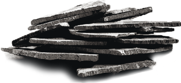
Ergitme Sonrasında Mikrokristalin Master Alaşım
